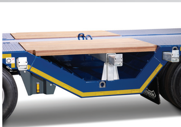
Remplissage des fosses à roues
