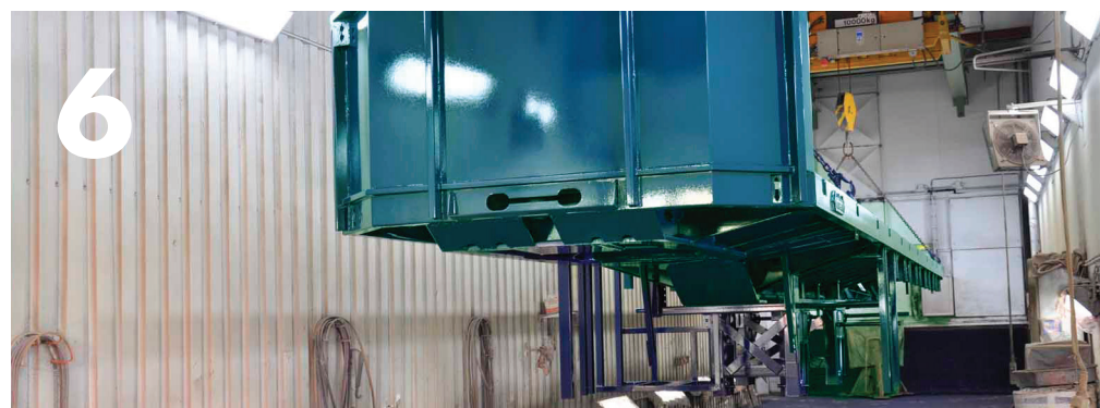
Le véhicule est peint par projection – mouillé sur mouillé – de 2 couches de peinture polyuréthane (PU) de haute qualité qui offre un brillant extrêmement durable et une très grande résistance aux rayures. La peinture permettra au véhicule de conserver un bel aspect pour environ les 10 à 12 années à venir.
