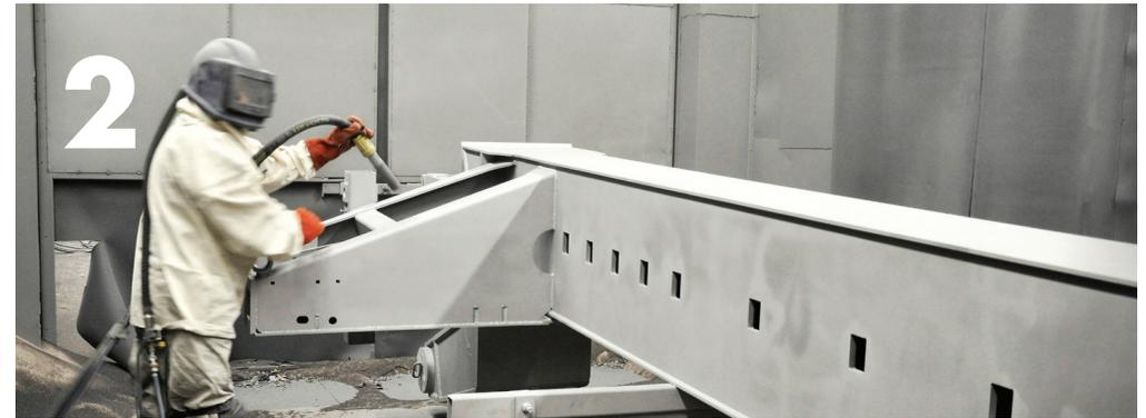
Das Fahrgestell wird mit Korund abgestrahlt. Das ist ein sehr hartes Aluminiumoxid, mit dem Rost und hartnäckiger Schmutz entfernt werden. Wenn das Fahrgestell den höchsten Reinheitsgrad erreicht hat, ist der Untergrund bereit für eine Feuerverzinkung.
