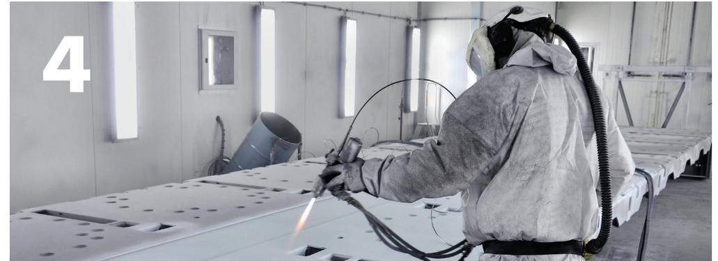
Feuerverzinkung des Fahrzeugs. Das ist die thermische Aufbringung einer Rost abwehrenden Aluminiumzink-Legierung. Nach dem Verzinken entsteht eine etwas raue Oberfläche, auf der der aufzutragende Primer sehr gut haftet.
