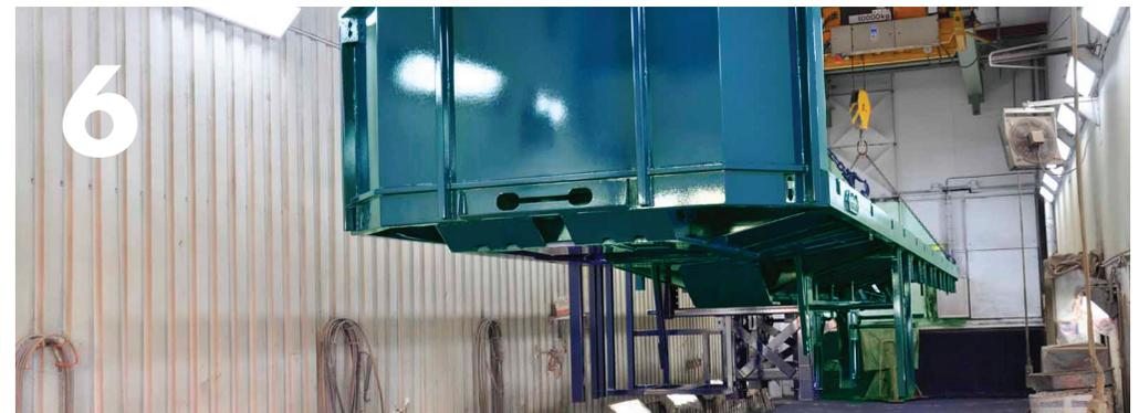
Der Auflieger wird – nass in nass in zwei Spritzlagen – mit einem hochwertigen Polyurethanlack (PU) mit optimaler Härte und Kratzfestigkeit und sehr hohem Glanzgrad lackiert. Die Lackschicht ist 10 bis 12 Jahre bestimmend für das Erscheinungsbild des Aufliegers.
