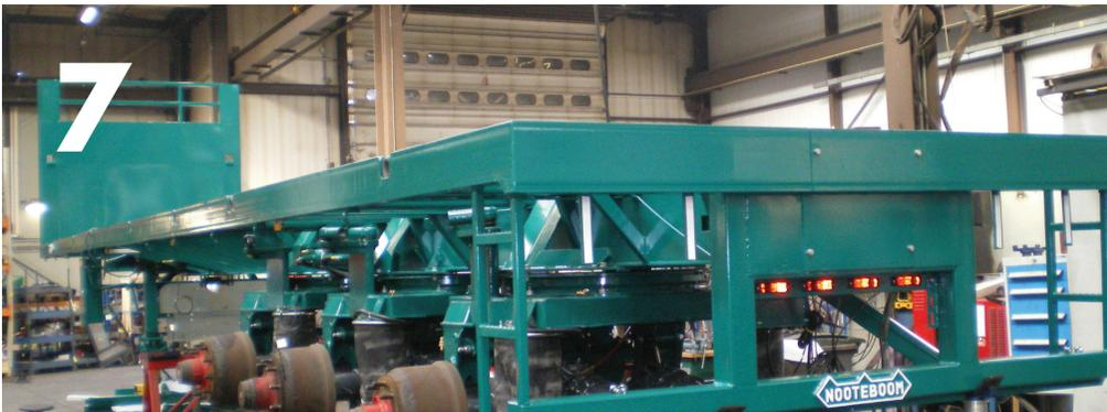
Alle lebenswichtigen Systeme und Einzelteile wie beispielsweise Zentralschmierung, Kabelbaum und Hydraulikleitungen werden erneuert.
